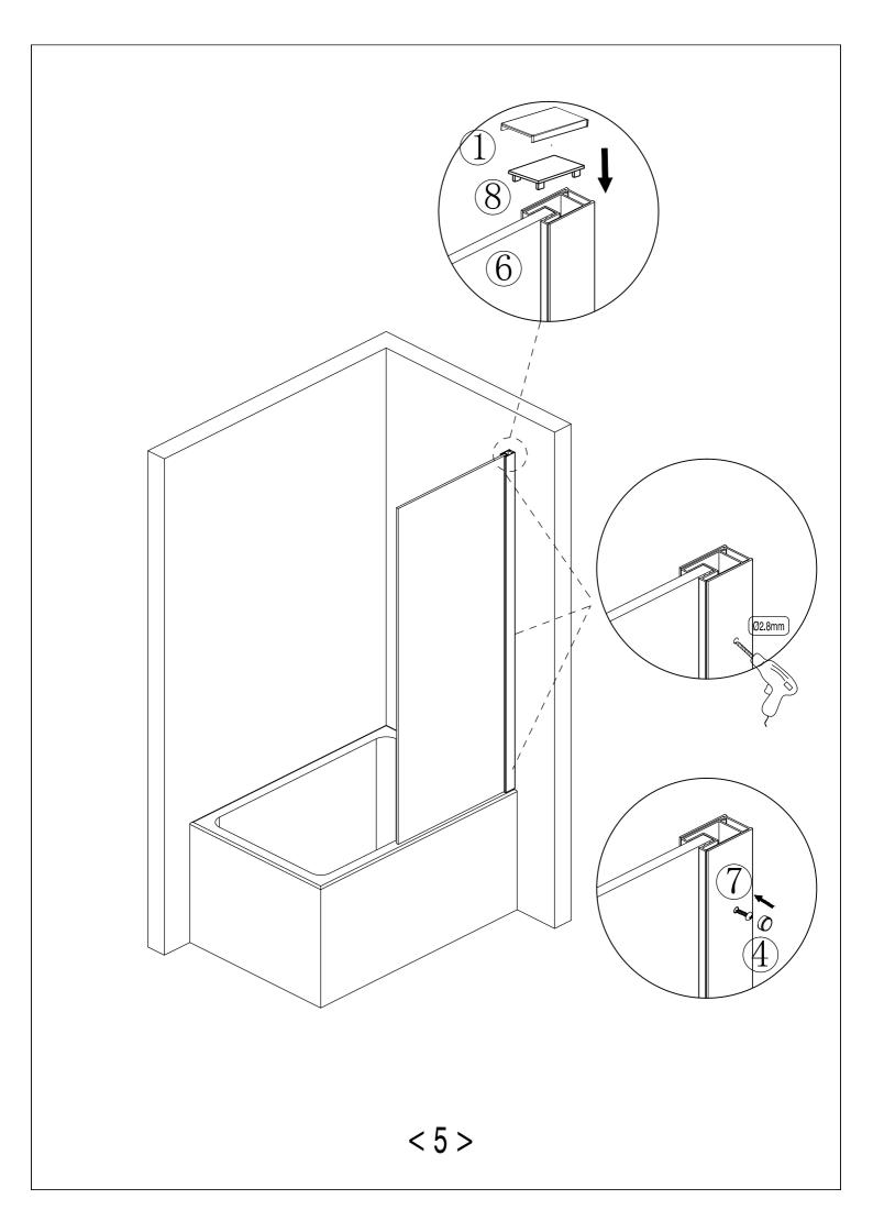
EXTERNALLY SILICONE SEAL THE WALL PROFILE WHERE IT MEETS THE WALL AND ALONG THE BOTTOM OF THE GLASS. ALL IN A CONTINUOUS BEAD. DO NOT SILICONE INSIDE THE ENCLOSURE
