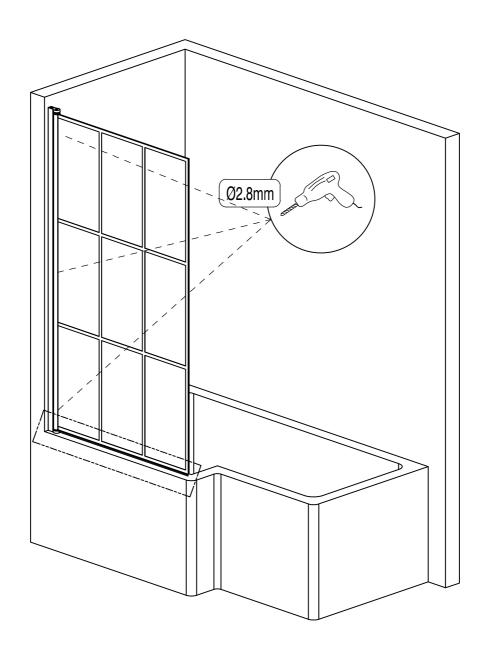
EXTERNALLY SILICONE SEAL THE WALL PROFILE WHERE IT MEETS THE WALL AND ALONG THE BOTTOM OF THE GLASS. ALL IN A CONTINUOUS BEAD. DO NOT SILICONE INSIDE THE ENCLOSURE
